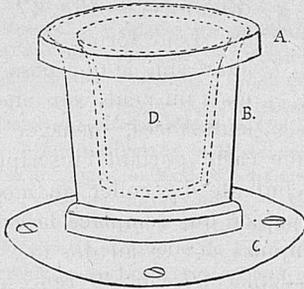
Fig. 53. Modèle d'encrier en tôle vernissée, visé sur la table avec couvercle en tôle, et godet en verre ou émail s'élevant librement. (Employé à la Bibliothèque de l'École supérieure de pharmacie de Paris).
