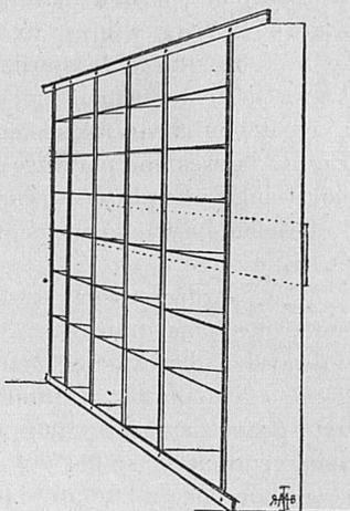
Fig. 3. Ensemble de rayonnage monté tout en tôle.
