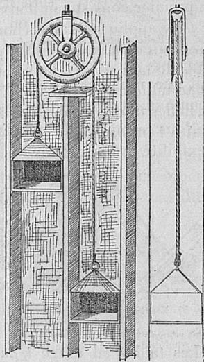
Fig. 41. Section de monte-charges à double boîte. Système le plus élémentaire. Vu de face.
