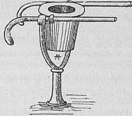
Fig. 54. Encrier fixé entre deux barres de fer servant de séparation médiane des tables; il se compose d'une partie tronconique en tôle dans laquelle on met un godet garni d'encre qu'on ne peut retirer une fois le couvercle rabattu. (En usage à la Bibliothèque de la Faculté de médecine de Paris).
