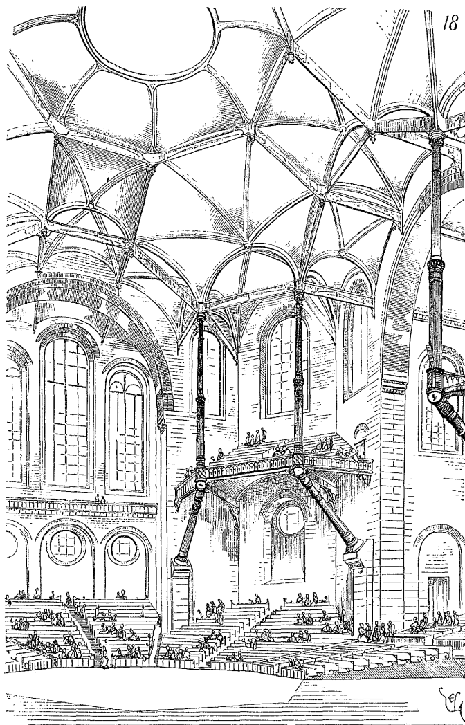
« Salle voûtée, fer et maçonnerie » 1864 Gravure d'E. Guillaumoi illustrant les « Entretiens sur l'architecture » de Viollet-le-Duc, tome II, douzième entretien figure 18 (Pierre Mardaga Editeur)
