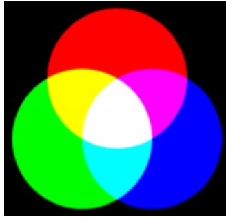
Schéma de représentation de la synthèse additive 15
