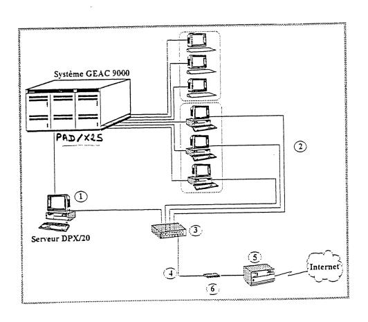
Dans le schéma ci-dessus le serveur DPX/20 (1) est placé entre le raccordement Internet de l'IRCAM (5) et le serveur GEAC 9000 afin de servir de passerelle entre les 2 protocoles d'accès (Internet/TCP-IP et PAD/X25)
