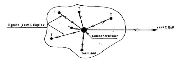
Un terminal doit être utilisé en ligne, c'est-à-dire en connexion avec un CD. On dit qu'il travaille "ON LINE".
