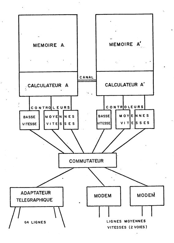
Le cycle de base d'un calculateur est de 1,6 ps. Les calculateurs des CD banalisés ont une mémoire de 16 K mots (1 mot 16 bits).
