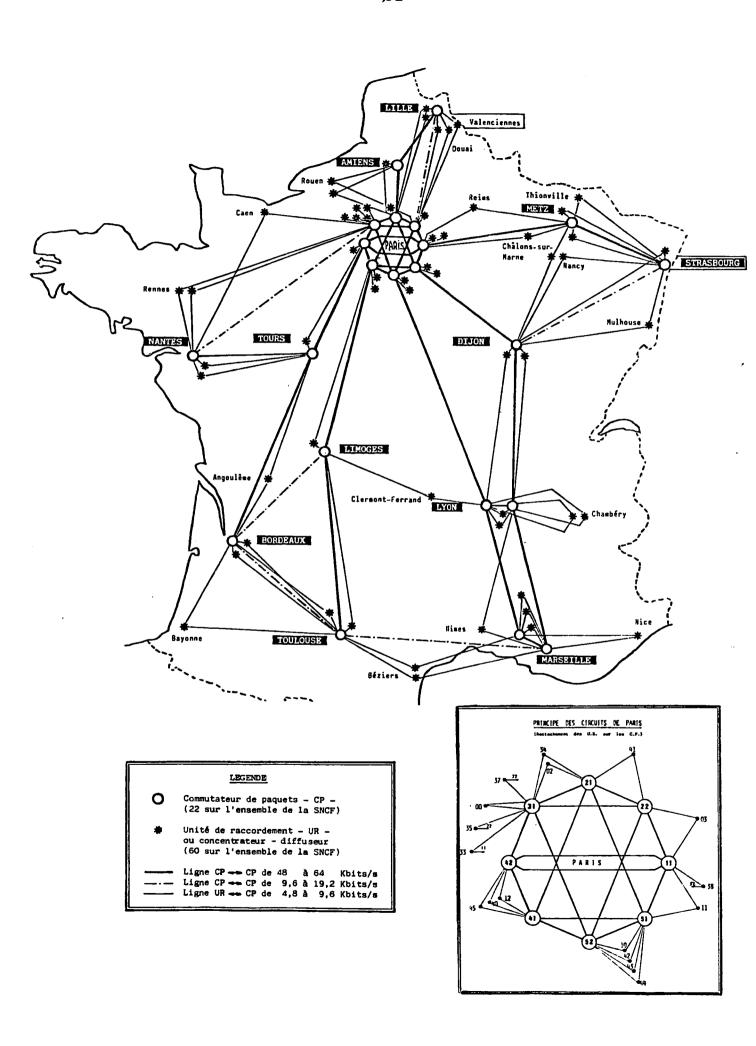
La commutation par paquets est une technique de transmission d'informations entre deux extrémités reliées par un réseau : l'extrémité émettrice découpe ses informations en blocs assez courts appelés "paquets" et les envoie à un noeud d'entrée du réseau. Les paquets sont commutés de noeud en noeud jusqu'à celui de sortie qui les envoie à l'extrémité réceptrice, laquelle reconstitue les informations à partir des paquets qu'elle reçoit.
