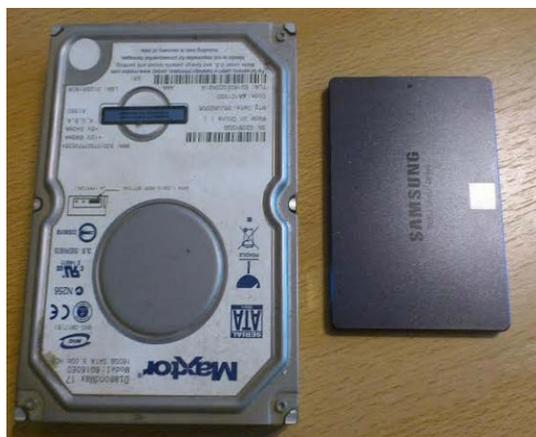
**Figure 1 : Comparaison d'un disque dur classique et d'un disque dur SSD**
