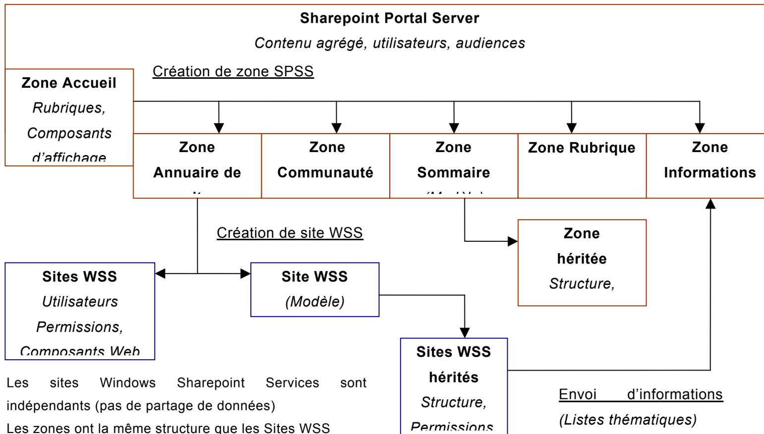
Figure 7 : Principes généraux des couches SPSS et WSS
