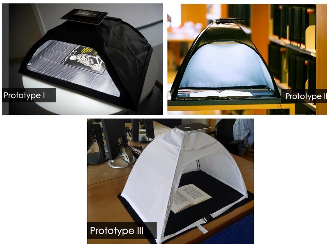
Figure 8. Trois prototypes de *ScanTent* actuellement en test. Source : Kleber, Diem, et Hollaus, « DocScan and the ScanTent ». Licence : [CC BY-NC-ND 4.0](https://creativecommons.org/licenses/by-nc-nd/4.0/).
