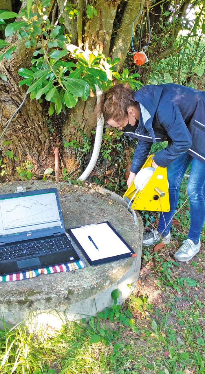
Un contrôle piézométrique pour le monitoring d'une nappe souterraine.
