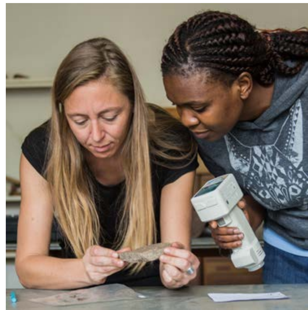
Analyse spectrophotométrique d'un fragment de paroi peinte issu de précédentes fouilles de l'abri de Pomongwe dans les Matobo, au Zimbabwe, et conservé au musée des sciences humaines du Zimbabwe à Harare. © Nicolas BAKER/TRACES/ARSCAN/CNRS Images
