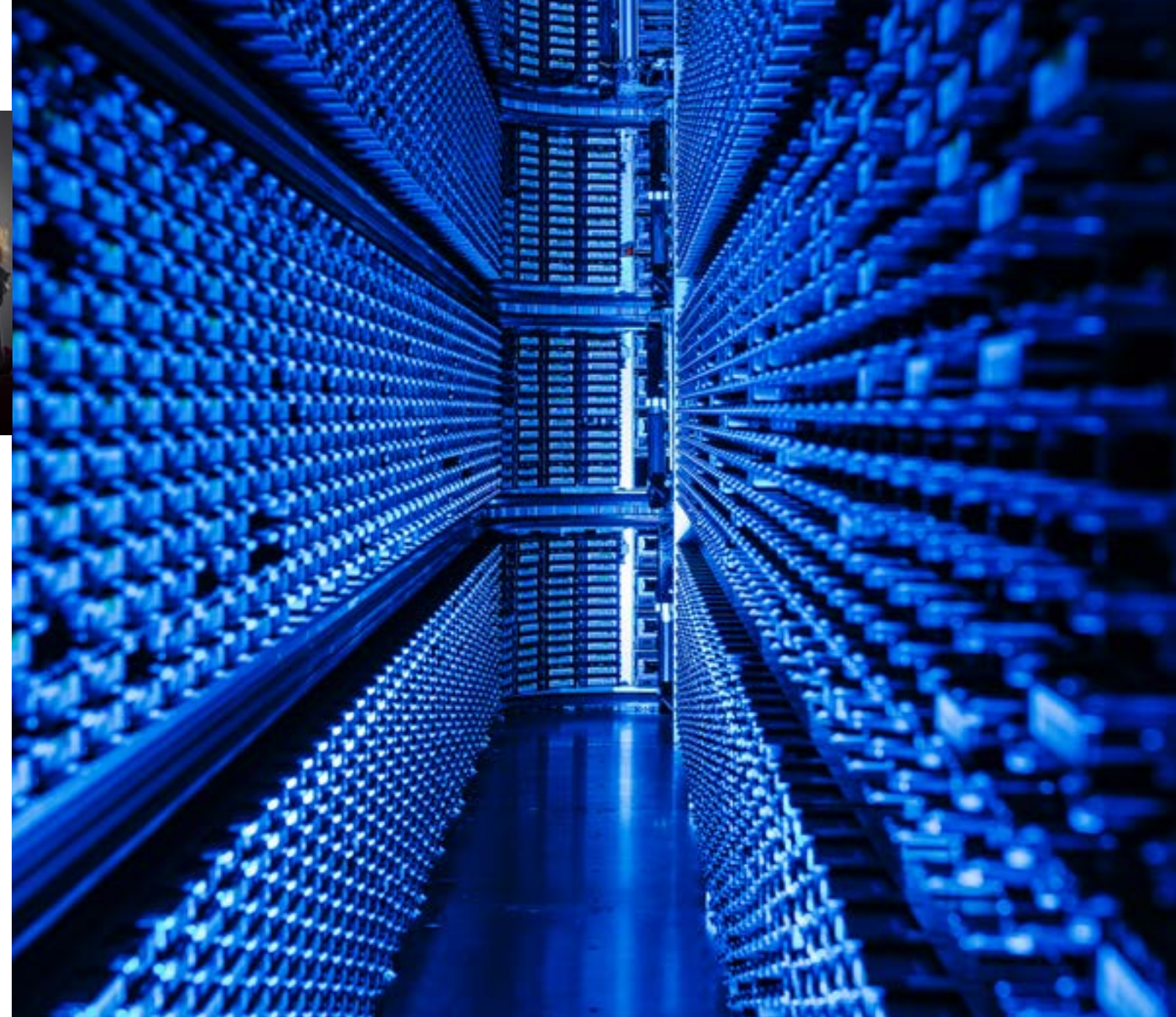
Bibliothèque de stockage à bandes magnétiques du CC-IN2P3. © Cyril FRESILLON / CC IN2P3 / CNRS Images
