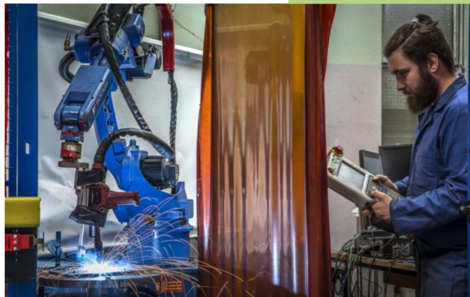
Fabrication d'une pièce en acier par le procédé de fabrication additive par fusion à l'arc électrique d'un fil métallique (WAAM), développé par le Laboratoire de mécanique et génie civil (LMGC) 1 . © Christophe HARGOUES / LMGC / CNRS Images
