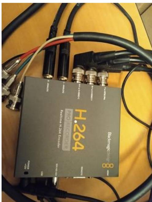
*Illustration 2: Boîtier de numérisation Blackmagic H.264 Recorder Pro utilisé pour numériser le fonds Graillet. ADCO.*
