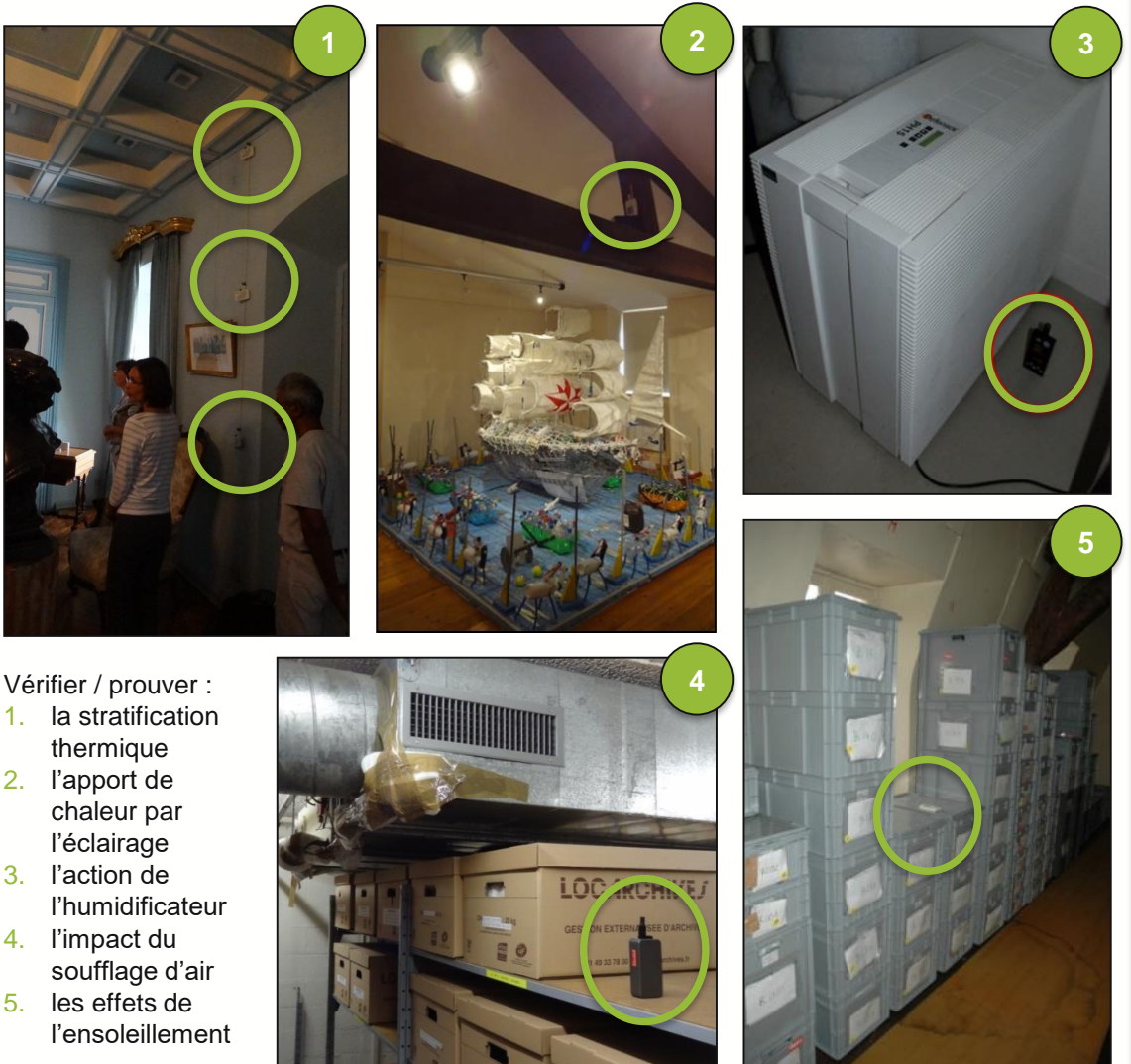
Différents emplacements de capteurs climatiques selon les objectifs
