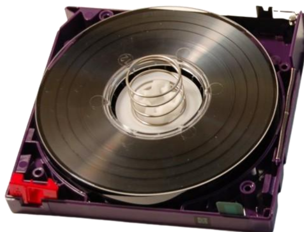
Figure 3 : Illustration d'une bande magnétique sans le haut de la cartouche 110
