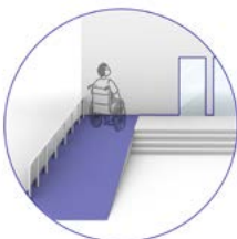
Rampe pérenne (pente inf. à 5°)
