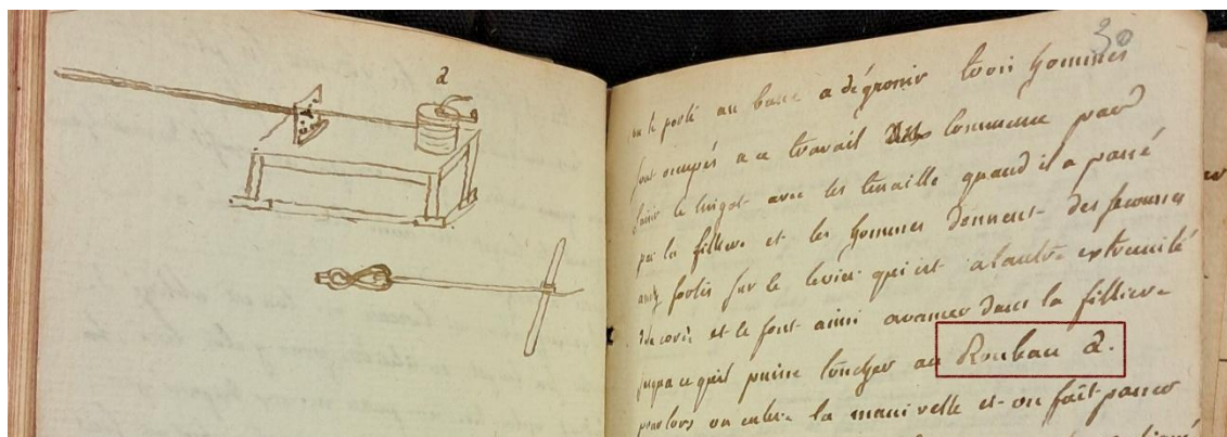
Figure 66. Schéma d'un banc à dégrossir et explication correspondante dans le texte, Journal de Paris à Gênes , f.29v-30
