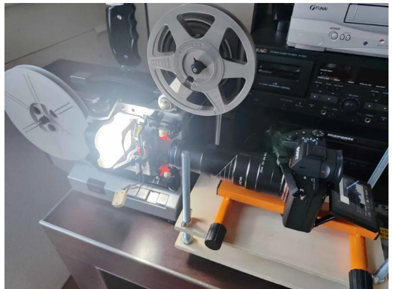
Installation d'un projecteur Super 8 éclairé et caméra numérique pour la conversion directe de films argentiques en format numérique
