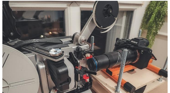
Configuration de numérisation avec projecteur Super 8, caméra numérique fixée en face pour capturer l'image du film lors de la projection.
